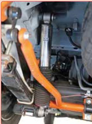
「速く走る」のではなく、あくまでも「安全・快適に走ること」を目的に、キャブコンの足回りをグレードアップ。足回り専門のプロショップで10回以上のダンバーセッティングを繰り返し、走行安定性と乗り心地を両立した理想の足回りに仕上げた。運転席は、ホールド感の高いフルバケットタイプに換装し、長距離運転の疲労を軽減している。
